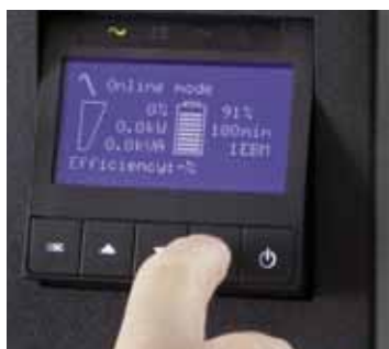
LCD на 9SX се завърта на 45° за по-лесно отчитане
